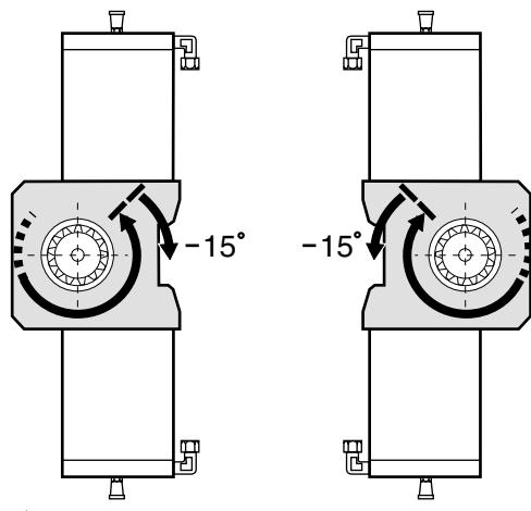
**Importante:** Ruotare il pignone del martinetto nel senso di chiusura fino al suo arresto e di circa 15° in senso opposto. Inserire il martinetto nella cassetta, chiudere l'anta e, agendo sui grani, sollevare il martinetto innestando il pignone con la boccola.
