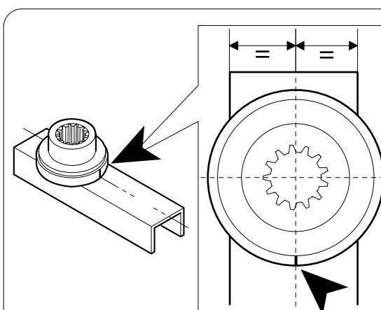
**Importante:** l'asse della boccola e l'asse della staffa guida devono essere allineati con la tacca di riferimento orientata verso il bordo esterno dell'anta come da figura.
